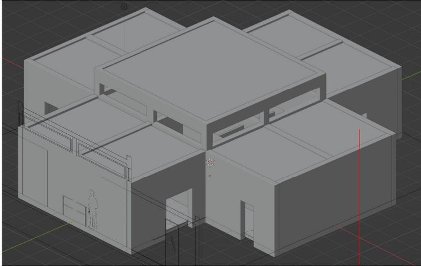
Sélectionner la **face basse** du mur et abaisser la via les commandes « **G** » puis « **Z** » jusqu'à la dalle de toiture. terrasse
